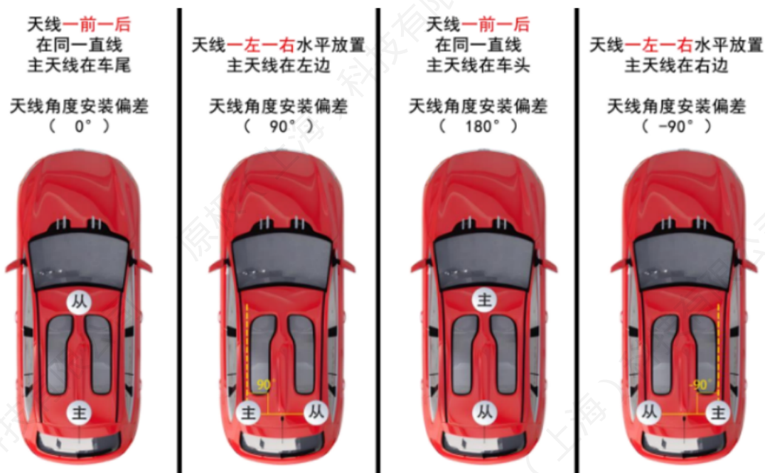
图 7 双天线安装示意图
